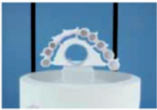
Правильное расположение на трегере для спекания
