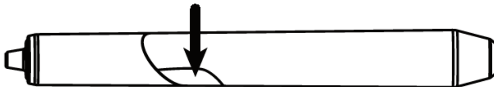
Рисунок 7 Схема установки внешнего корпуса для наконечника
